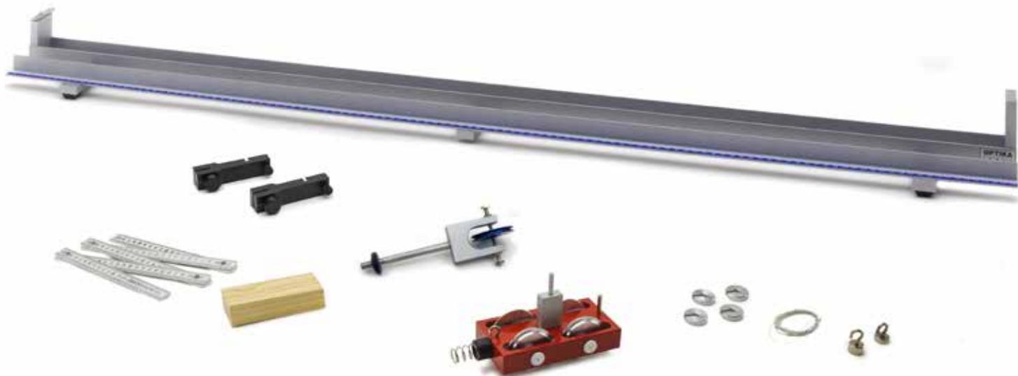
El movimiento está sujeto a fuerzas de fricción que se pueden reducir, pero no eliminar. Gracias a la baja fricción en el carril se puede llevar a cabo, experimentos sobre cinemática y movimiento de traslación.
