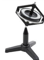
Rueda giroscópica en metal. Poniéndola en rápida rotación a través de una cuerda, se puede verificar la conservación del momento angular. Si se aplica una fuerza perpendicular al eje de rotación, es posible observar el fenómeno de la precesión o bien el efecto giroscópico.
