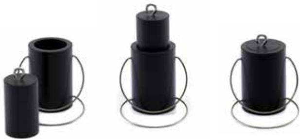
Cilindro cavo (misure esterne):  $h = 60 \text{ mm}$ ;  $d = 41 \text{ mm}$
